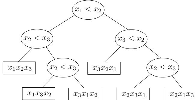
Obrázek 3.1: Příklad rozhodovacího stromu pro 3 prvky
