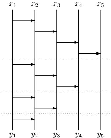
Obrázek 15.6: Bublinkové třídění
