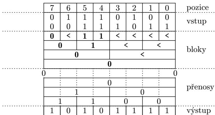
Obrázek 15.4: Průběh paralelního sčítání pro  $n = 8$
